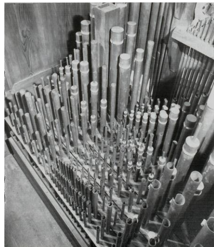
Einblicke in "Tractor und Pfeifenwerck" der Silbermann-Orgel
